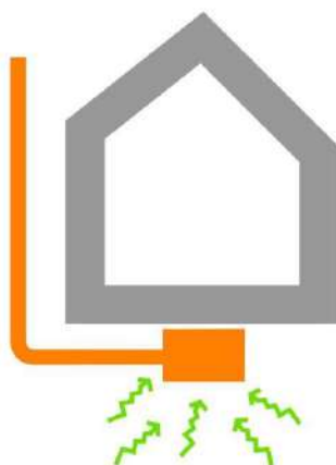
Figura 13: depressione del sottosuolo tramite pozzetto.
