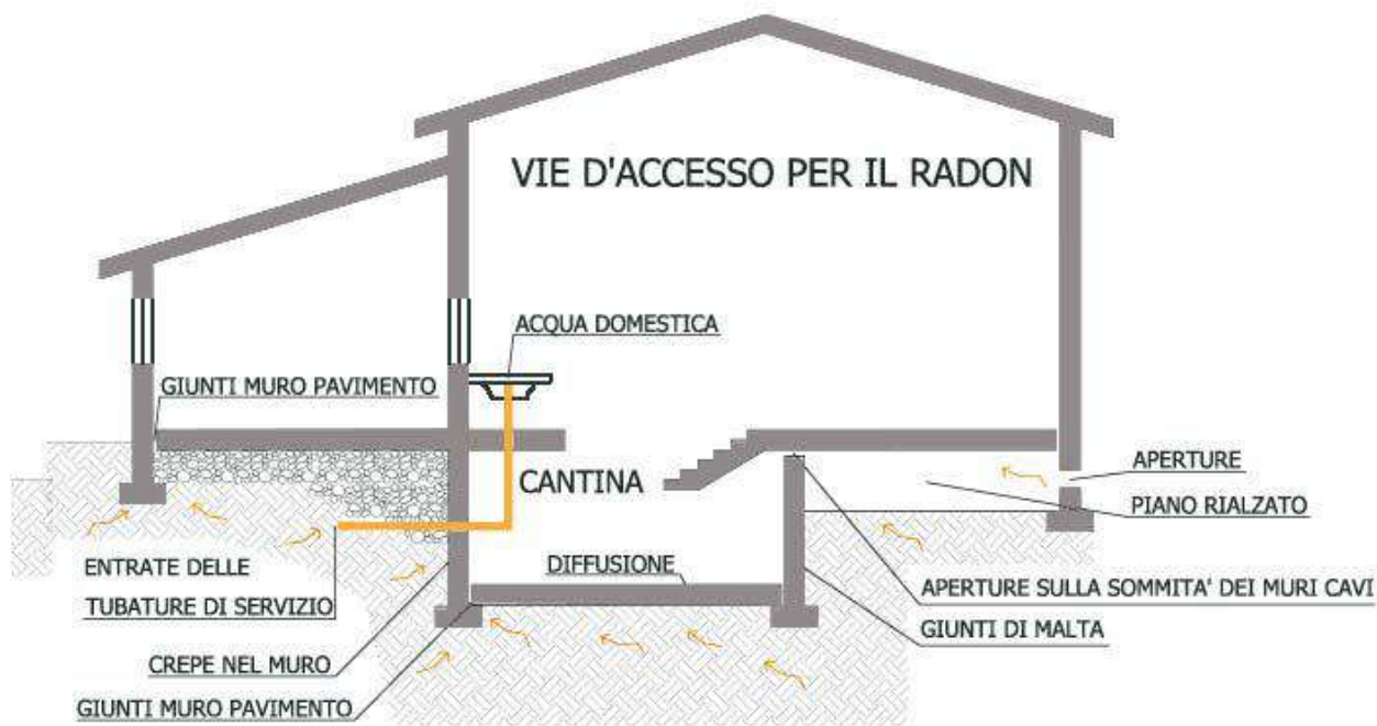
Figura 5: vie d'accesso per il radon
